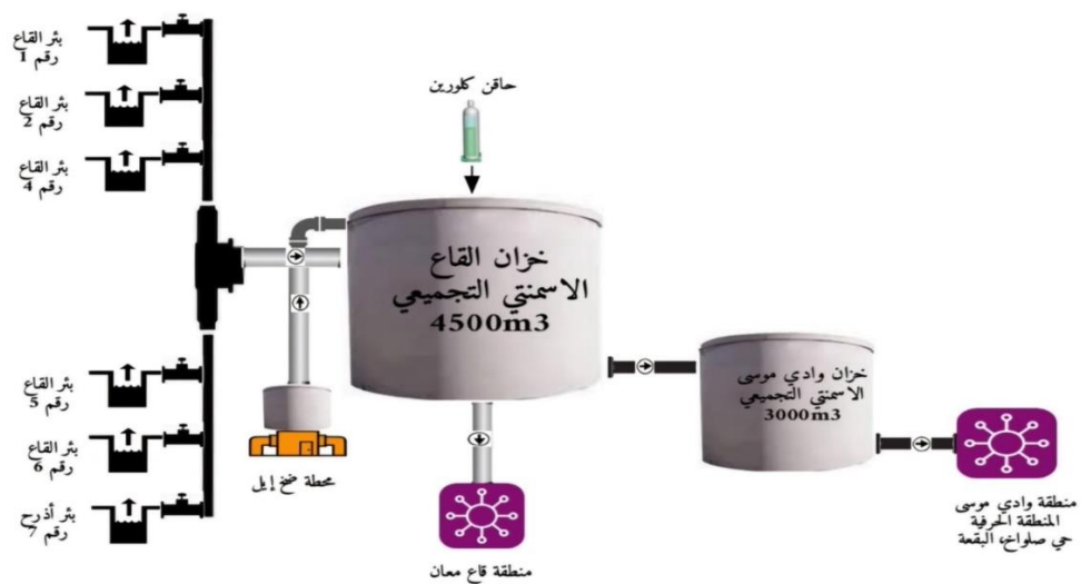
الشكل 4. الخزانات التجميعية التي تغذي إقليم البتراء بمياه الشرب
